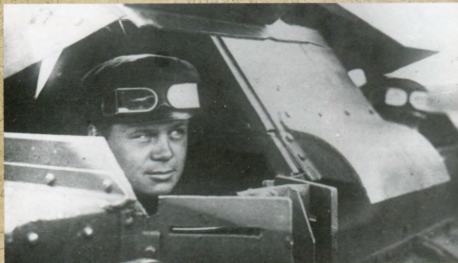
★ Танкист на месте стрелка в танкетке Т-27. Хорошо видна конструкция амбразуры для установки пулемета ДТ.
