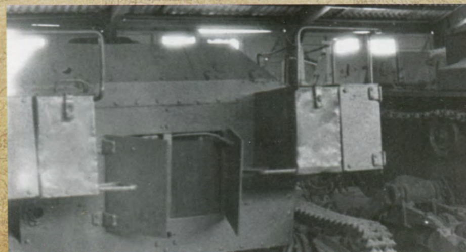
★ Вид сзади на танкетку Т-27. Дверцы перед радиатором открыты.
